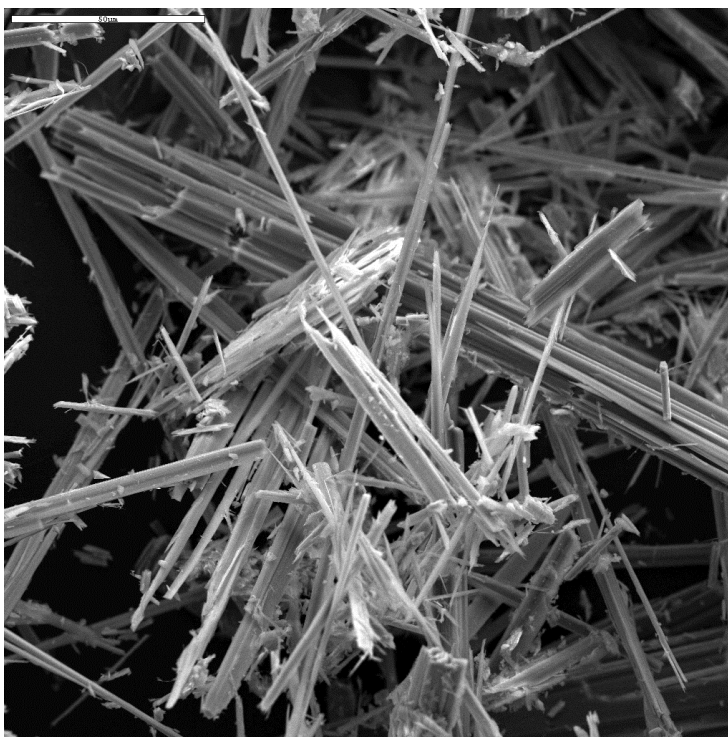
Fibre di amianto al microscopio – Fonte Wikipedia
