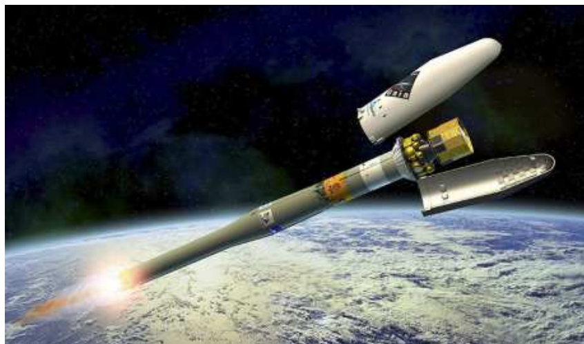
Il razzo vettore russo Soyuz ST con il blocco d'accelerazione Fregat MT che ha portato in orbita il satellite europeo Gaia. Crediti: ESA
