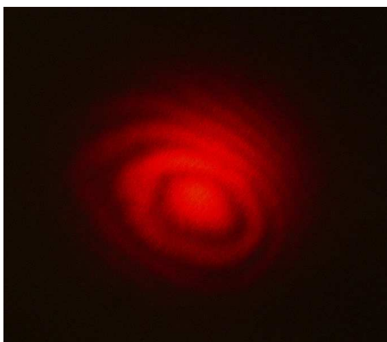
Figura 5 Figura di interferenza prodotta da un laser rosso con l'apparo sperimentale di Michelson-Morley. Le linee chiare sono le frange di interferenza costruttiva, mentre quelle scure sono quelle di interferenza distruttiva. Fonte: Wikipedia
